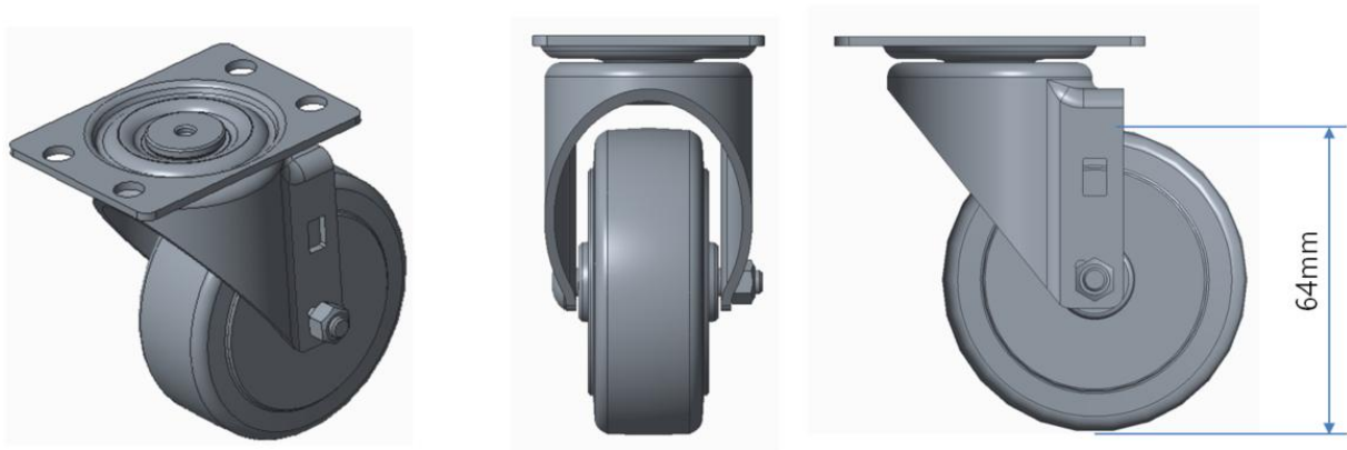
<그림 2-4> Dimensions of Rear Caster
